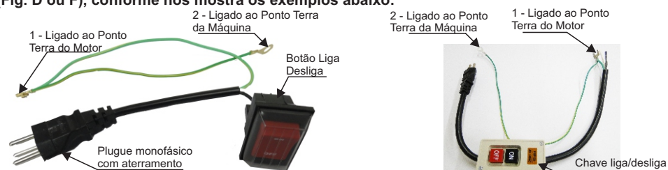
Fig. A - Conjunto chave de partida monofásica bet. 150L Premium
